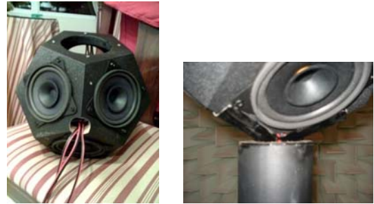
Fig. 7. Perforación para cableado y soporte del dodecaedro.
